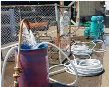
給水速度をMAX状態で給水しながら、排水をAO-102一機で排水する速度を比較しました。
